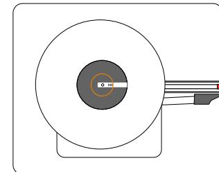
Der rote Punkt an der Unterseite der Hitzdrahtsonde muss dem Luftstrom zugewandt sein.
